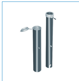
Bodenhülse, 2 teilig, ca. 1,2 kg Maststärke: Ø 55 mm Klemmschraube, Abdeckkappe Material: Aluminium Art.Nr.: 490793
