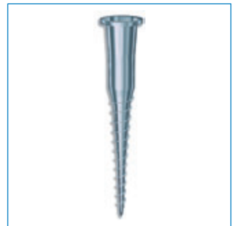
Schraubfundament Standrohrst.: Ø 76/90/110 mm auf Anfrage
