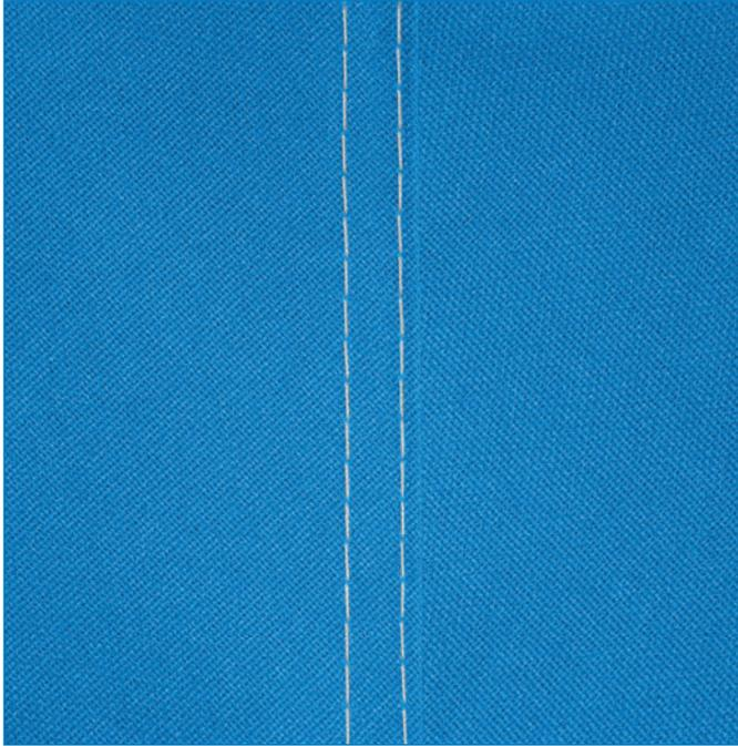
Widerstandsfähige Kappnaht zum Verbinden der Segmente.
